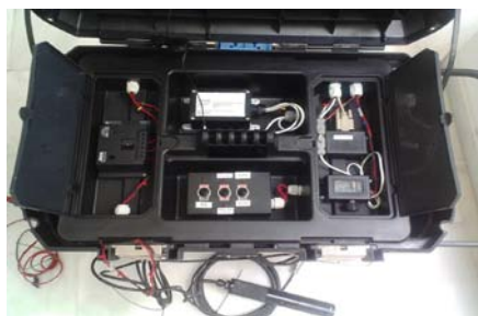
Σχήμα 4: Το εσωτερικό του SedTrap node
