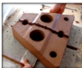
Κατασκευή της βασικής δομικής μονάδας του συστήματος «Plethro»
