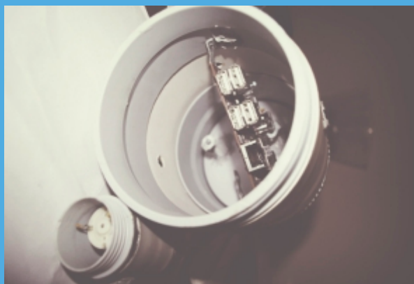
Το εσωτερικό του σκάφους με ενσωματωμένα τα ηλεκτρονικά μέρη (BeagleBoard & Επιταχυνσιόμετρο)
