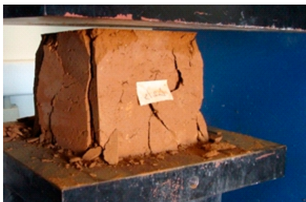
Θλιπτικές δοκιμές των δοκιμίων
