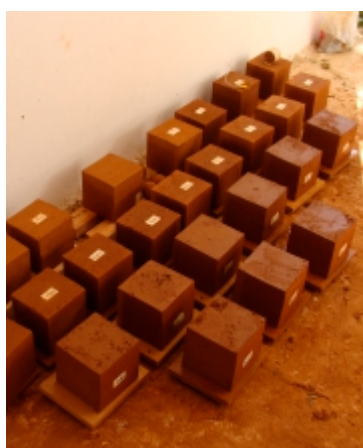
Κυβικά δοκίμια που κατασκευάστηκαν από την ομάδα για τη μέτρηση των μηχανικών ιδιοτήτων του μείγματος
