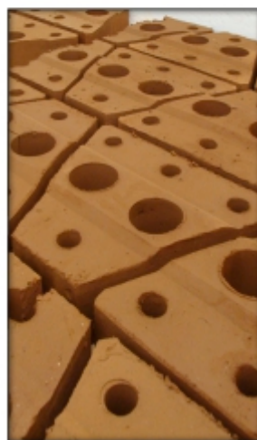
Κατασκευή της βασικής δομικής μονάδας του συστήματος «Plethro»
