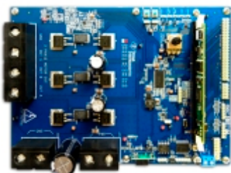
Ο ελεγκτής του ηλεκτρικού κινητήρα
