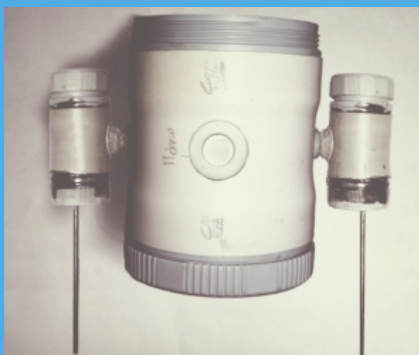
Συναρμολόγηση του σκάφους με δύο εκ των τριών μονάδων προώθησης
