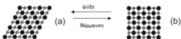
Κρυσταλλική δομή κράματος μνήμης σχήματος Ni-Ti: μαρτενσίτη [a] και οστενίτη [b]
