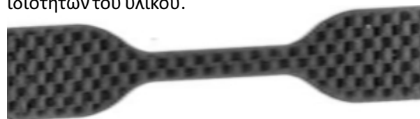
Δοκίμιο του υλικού για μετρήσεις εφελκυσμού. Διακρίνονται το υφάδι και το στημόνι του ανθρακοϋφάσματος. Εδώ η κατεύθυνση μέτρησης είναι αυτή του στημονιού.
