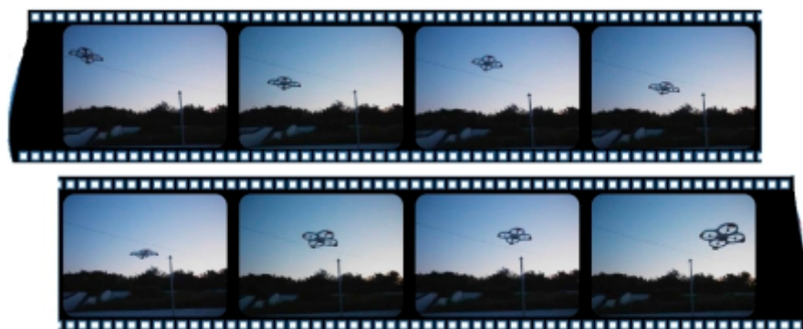
Εξωτερική δοκιμή UAV για την αποφυγή σύγκρουσης με πομπό WiFi τοποθετημένο σε στύλο
