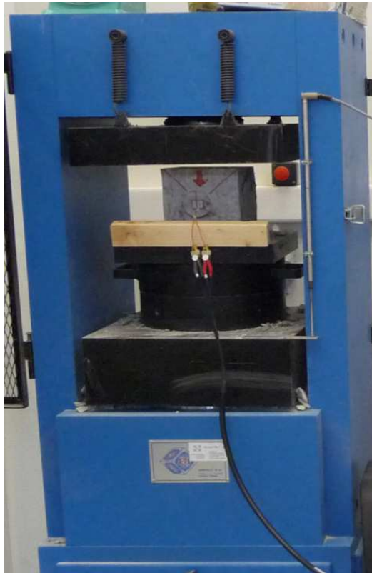
Θλιπτική καταπόνηση δοκιμίου σκυροδέματος
