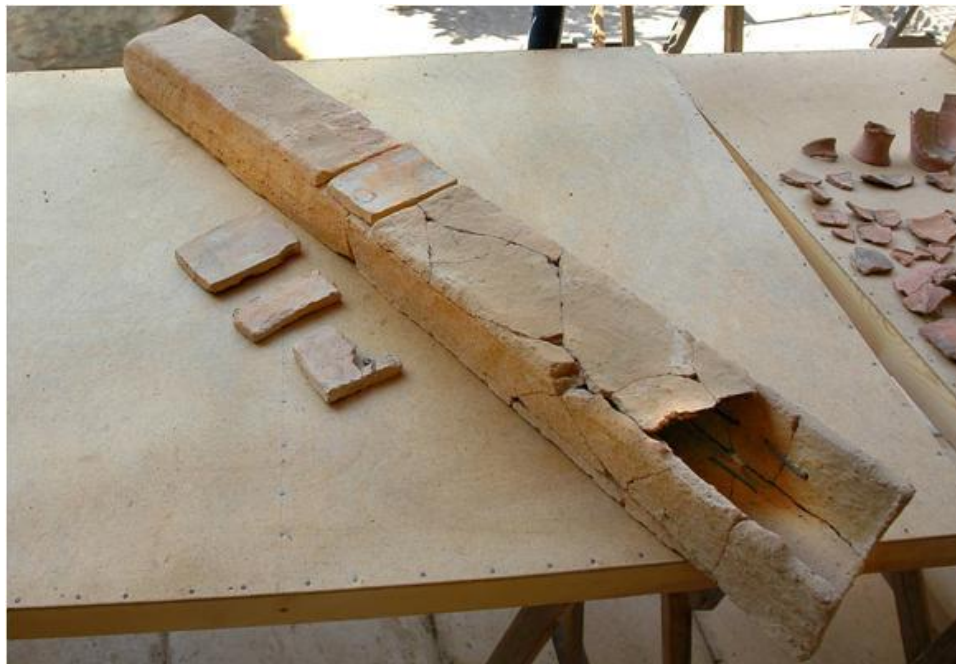
Σωλήνες δικτύου συλλογής ομβρίων νερών παραλληλόγραμμης διατομής
