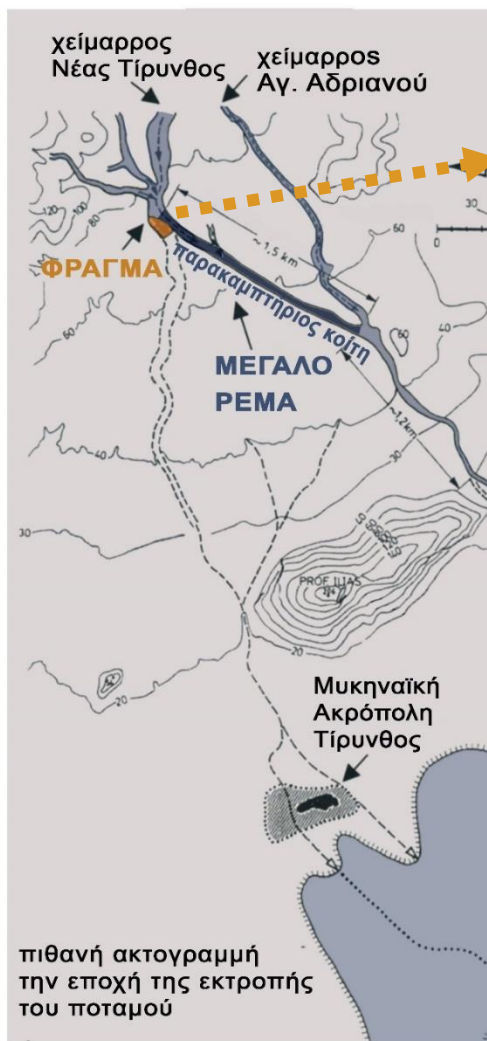
Εικ.1.1. Το μυκηναϊκό έργο εκτροπής του Τίρυνθος ποταμού, μέσω μεγάλου χωμάτινου φράγματος, (14 ος αι. π.χ.χ.).
